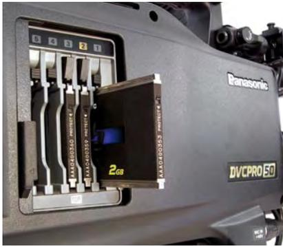
Um längere Aufnahmezeiten zu realisieren, weisen P2-Geräte mehrere Slots auf.
