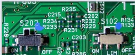
Die beiden Schalter sind beschriftet mit S202 und S102. Die beiden ON-Positionen, wie in unserem Bild, bedeuten: Die Limiter sind eingeschaltet.
