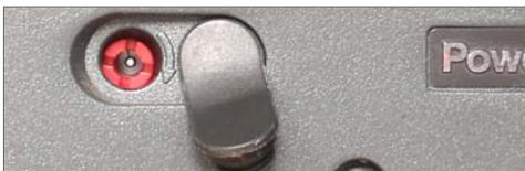
Der Kassettenauswurf per **EJECT** ist nur bei eingeschaltetem Kamerarecorder möglich. Für Notfälle ist unterhalb des Kassetteneinschubs unter einer Abdeckung die von analogen Kamerarecordern bekannte mechanische Öffnung des Kassetteneinschubs möglich.
