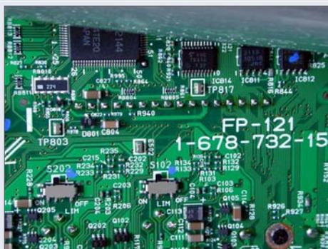
Der Kamerarecorder wird geöffnet (Display-Seite). In der geöffneten Klappe befindet sich das Board FP-121, zunächst verdeckt durch eine flexible Abdeckung. Darunter gesucht werden müssen nun die beiden Schalter für CH-1 und CH-2.
