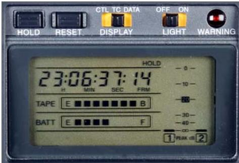
► BATT-Anzeige. Abhängig vom verwendeten Akkusystem kann diese Anzeige präzise die Akku-Daten anzeigen (z.B. IDX, Digi View).
