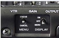
Voraussetzung ist zunächst, dass die Audio-Wahlschalter **AUDIO SELECT** auf manueller Aussteuerung und natürlich auf **FRONT** stehen. Anschließend erreicht man die Audio-Pegelanzeige im Sucher durch folgende Vorgehensweise: Schalter **DISPLAY** auf **ON**, dann wird der Menüschalter auf **CANCEL** geschaltet.
