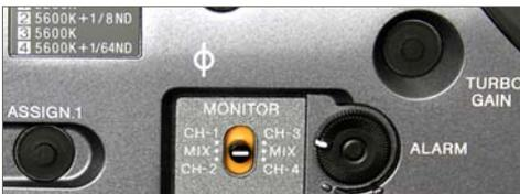
Dieser neue Turbo-Taster ist im Grunde ein ASSIGN.-Taster, den man bei Bedarf mit den Aufgaben des alten TURBO GAIN Tasters belegen kann. Umgekehrt lassen sich die Verstärkungsstufen, die sich dem Turbo-Tasters mit der Menü-Seite GAIN SW fast jeder ASSIGN-Taste zuweisen. Einzelheiten dazu sind auf Seite 319 beschrieben.
