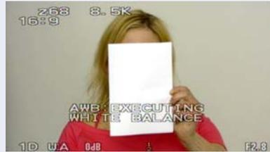
Ist man ungeduldig (mit dem PDW-530 kann es mehrere Sekunden dauern!) und entfernt die Weißfläche zu früh, wird man mit der Anzeige **AWB: BREAK** (Abbruch) bestraft und eine Wiederholung ist nötig. Diesmal hat es geklappt – **AWB: OK**. Erforderlich, um diese wichtigen Einblendungen zu sehen, ist die Aktivierung von **VF DISPLAY MODE 3**.
