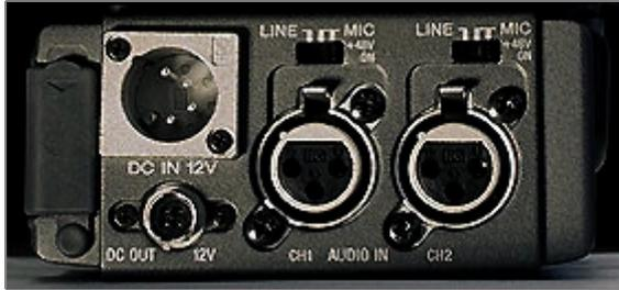
Wie bei anderen Profi-Schulter-Camcordern von Sony, lässt sich auch beim DSR-250 eine Aufsteckleuchte direkt am Camcorder einstecken, aus dem Camcorder-Akku speisen und auf Wunsch mit der Aufnahmetaste gekoppelt ein- und ausschalten.
