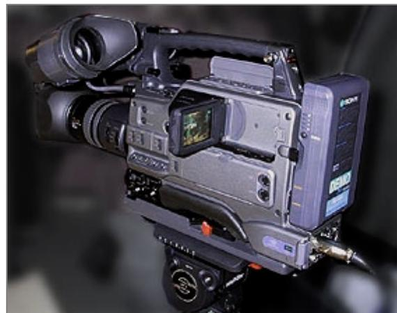
**Per Stativplatte passt der DSR-250 auf jedes professionelle Videostativ. Zusätzlich zum Schwarzweiß-Röhrensucher gibt es auch ein ausklapp- und drehbares Farb-LC-Display.**
