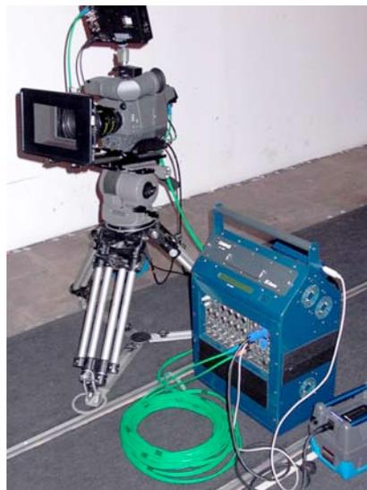
magazine gestatten es, ohne nennenswerte Verzögerung zu drehen. Dabei liegt dank der Hot-Plug-Fähigkeit der HD-Magazine die Wechselzeit weit unter der Wechselzeit von Filmmagazinen. Aufgrund der Mobilität der Geräte kann der DI-Prozess schon am Set beginnen.
