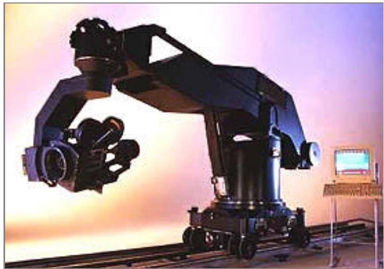
**Motion-Control-Systeme sind motorisierte, computergesteuerte Kamerakräne, mit denen sich vorprogrammierte Kamerabewegungen exakt ausführen und mehrfach hintereinander wiederholen lassen. (Foto: Mark Roberts Motion Control)**
