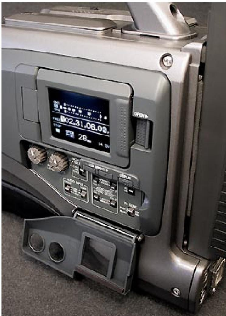
Alles aufgeräumt: Timecode- und Audio-Schalter verschwinden hinter einer Klappe.
