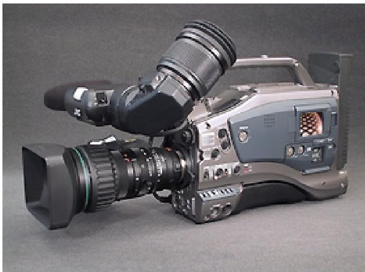
**Der GY-DV5000 ist ein Schulter-DV-Camcorder im typischen Profi-Design. Er ist mit einem Wechselobjektiv ausgerüstet. Bild und Ton schreibt er im DV-Format direkt auf Mini- oder Standard-DV-Kassetten.**
