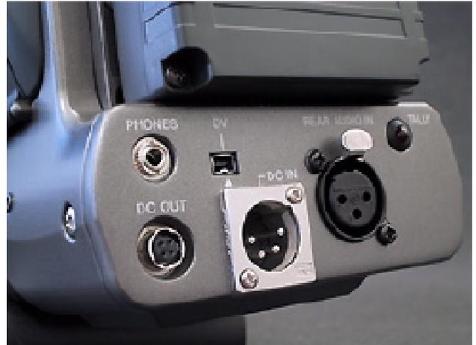
**Nur eine XLR-Buchse an der Geräterückseite, DV nur als Ausgang beschaltet.**
