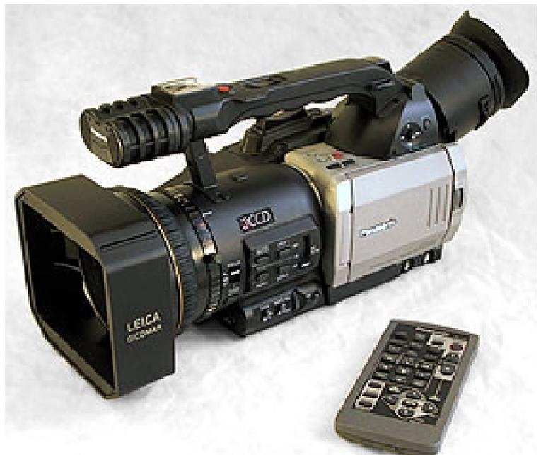
**Der AG-DVX ist ein kompakter 3-CCD-Camcorder aus der VX2000-Klasse. Anders als andere Semi-Profis wurde er speziell für den Profimarkt konstruiert und ist deutlich mehr als ein leicht abgewandeltes und angereichertes Consumer-Modell.**
