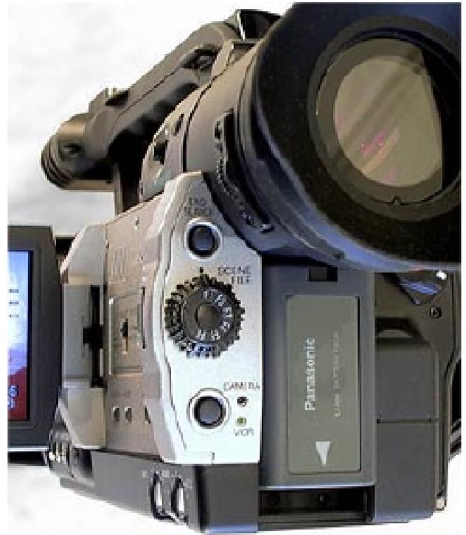
Mit dem Drehrad an der Camcorder-Rückseite werden die Scene Files aufgerufen.
