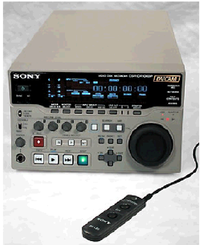
Die mitgelieferte, simple Kabelfernbedienung wird an der Control-Buchse angeschlossen.
