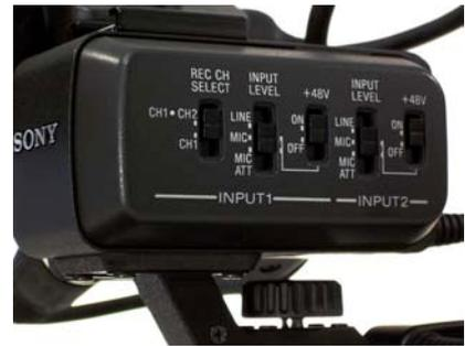
Der Audioadapter bietet unter anderem kanalweise Einstellmöglichkeiten für Empfindlichkeit, Phantomspannung und Hochpassfilter.
