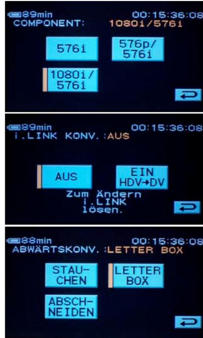
Hierüber lassen sich HDV-Signale wahlweise in 1080i, aber auch in 576i und 576p ausgeben. Im Menü »Down Convert« sollte zusätzlich noch eingestellt werden, was aus einem HDV-16:9-Bild werden soll, wenn es über die analogen Ausgänge ausgegeben wird: Soll es als Letter-box-Bild oder mit abgeschnittenen Seitenrändern in 4:3 wiedergegeben werden?
