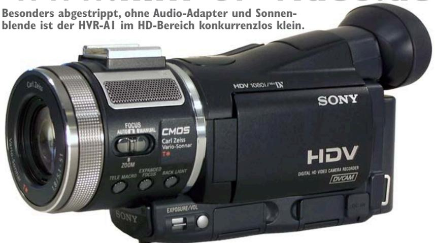
zugreifen könnte. Noch weit mehr, als man das von anderen Kompakt-Camcordern schon kennt, wird der A1 über Bildschirmmenüs bedient. Zudem hat Sony beim A1 das Ausklapp-Display als Touchscreen ausgeführt: Auf dem Screen werden Tasten simuliert, die man dann mit dem Finger drückt. Selbst Laufwerkstasten fehlen dem Camcorder gänzlich, auch diese Grundfunktionen werden über den Touchscreen gesteuert. Alle typischen Menüeinstellungen muss man ebenfalls auf diese Weise vornehmen.
