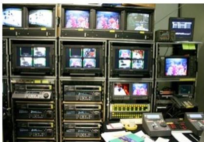
Bei ARD und ZDF sind vorwiegend IMX-Maschinen, aber auch Digital-Betacam- und DVCPRO-HD-Mazen im Einsatz.
