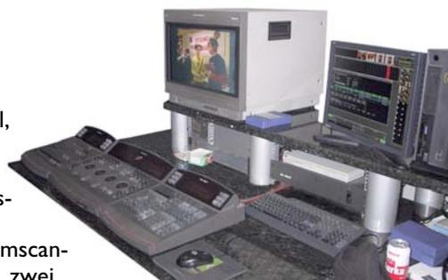
Ein DaVinci-2K-System arbeitet bei Imaj mit dem Diskrecorder HDStation-Plus von DVS und einem Thomson-Voodoo-Recorder zusammen. Gefüttert wird das Color-Grading-System von einem Cintel-DSX-Scanner. Neben dieser Top-Suite steht auch noch die Kombination aus einem Rascal-Abtaster von Cintel und einem Pogle-System oder einem Ursa-Gold-Telecine und einem weiteren Pogle für die Lichtbestimmung zur Verfügung.
