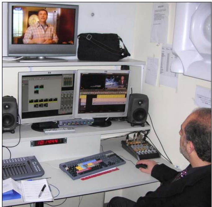
Im Ingest-Bereich stehen bei Skai drei Sonaps-Workstations, wobei jede dieser Stationen im Havariefall die Funktion jeder anderen Sonaps-Workstation im Haus übernehmen kann. Nach dem Ingest des Hi-Res-Materials stehen die Dateien hierbei als MPEG-IMX-Dateien mit einer Datenrate von 30 Mbps zur Verfügung – normalerweise für eine Woche. Der Online-Speicher umfasst dabei eine Kapazität von 350 Stunden Material.
