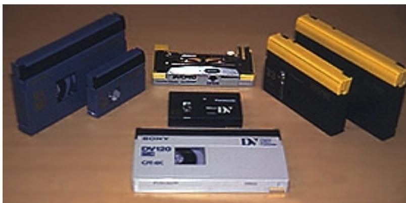
**Kassetten in den für die Formate definierten Größen: Links DVCAM, vorn Mitte DV, rechts DVCPRO. In der Mitte hinten: Der mechanische Adapter mit dem sich Mini-DV-Kassetten in DVCPRO-Geräten abspielen lassen.**
