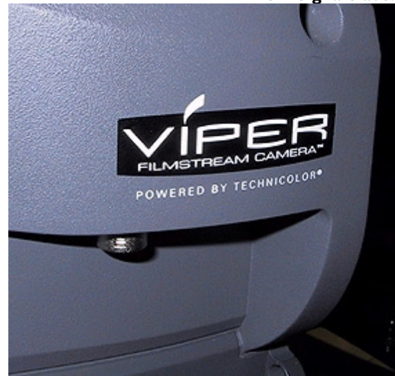
Ein neuer Ansatz für den Einsatz digitaler Kameras im Spielfilmbereich: Viper von Thomson gibt unkomprimierte RGB-Signale aus.
