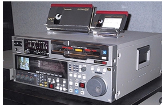
Kann 124 Minuten HD pro Kassette aufzeichnen: AJ-HD1600 von Panasonic.
