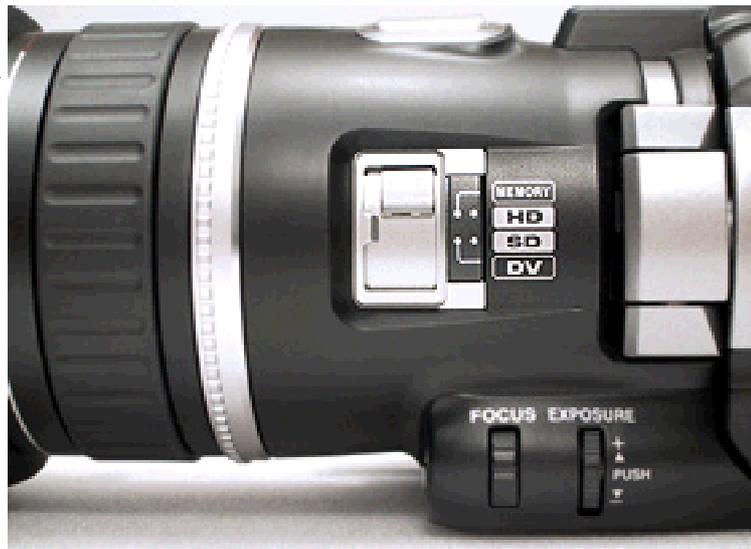
Zwei weitere Aufzeichnungs-Modi unterscheiden den HD10 aber vom Rest der DV-Camcorder-Welt. Stellt man den Schiebeschalter auf HD oder SD, schreibt der HD10 ein MPEG-2-Signal auf das DV-Band. Konkret: Im SD-Modus zeichnet der JVC-Camcorder 60 MPEG-2-komprimierte progressiv abgestastete Bilder mit 480 aktiven Zeilen in 16:9 pro Sekunde auf. Im HD-Modus bleibt das Seitenverhältnis gleich, die Bildrate liegt bei 30p, allerdings wird
