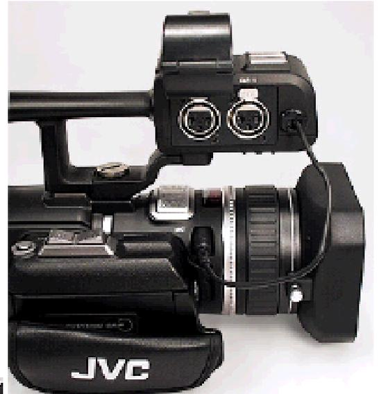
**Das »ProPad« bringt XLR-Buchsen mit, die ein dünnes Klinkenkabel mit dem Mikro-Eingang des JY-HD10 verbindet.**
