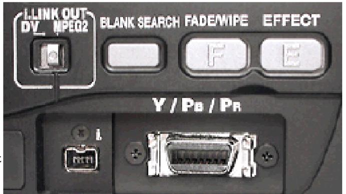
i.Link als digitale Schnittstelle für DV- oder MPEG-Daten. Analoges YUV in verschiedenen Auflösungen und Scan-Modi, sowie NTSC-Signale in Y/C oder Composite via Spezialbuchse: Die neue Video-welt hält viele Formate bereit.
