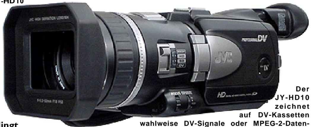
Der JY-HD10 zeichnet auf DV-Kassetten wahlweise DV-Signale oder MPEG-2-Datenströme in SD- und HD-Auflösung auf. Das alles geschieht gemäß amerikanischer Norm, im Vollbildmodus (progressiv) und im 16:9-Format. Dank eines integrierten Formatwandlers ist es möglich, das aufgenommene Material intern zu konvertieren und in unterschiedlichen Auflösungen und Formaten aus zu geben.
