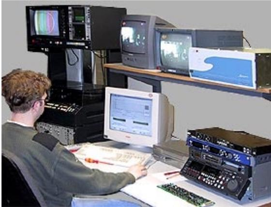
**Zehn solcher PC-gestützter Kopierplätze will das ZDF parallel betreiben, um insgesamt rund 72.000 Programmstunden von 1"-B- auf DVCPRO50-Bänder zu kopieren. (Das Bild zeigt einen Testaufbau).**
