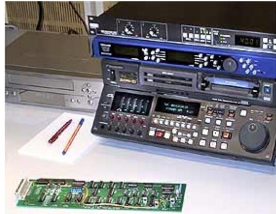
**Eine eigentwikelte Platine ermöglicht die Steuerung der BCN-51 auf der Zupielseite, da diese ja nicht über eine RS-422-Schnittstelle verfügt, wie der DVCPRO50-Recorder sie aufweist.**
