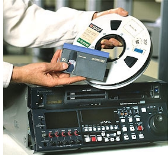
Höhere Speicherdichte spart Platz im Archiv: von 1“-B wird auf DVCPRO50 umkopiert
