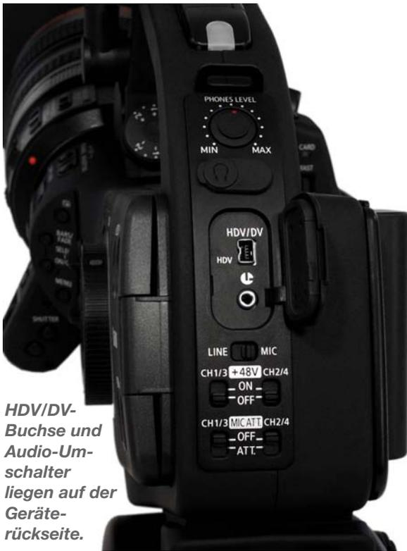
HDV/DV-Buchse und Audio-Umschalter liegen auf der Geräte-rückseite.
