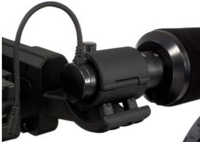
Das mitgelieferte Mikrofon ist in Gummi gelagert und recht gut vom Gehäuse des Camcorders entkoppelt. Besondere Auffälligkeiten im Tonbereich brachte der Test nicht zutage.
