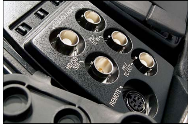
JVCs GY-HD251 bietet auch I/Os für Timecode, Genlock sowie Studio-Remote-Anschluss.
