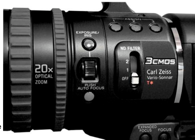
CMOS-Sensoren und 20fach-Zoom kennzeichnen die Bildwandlung des V1.
