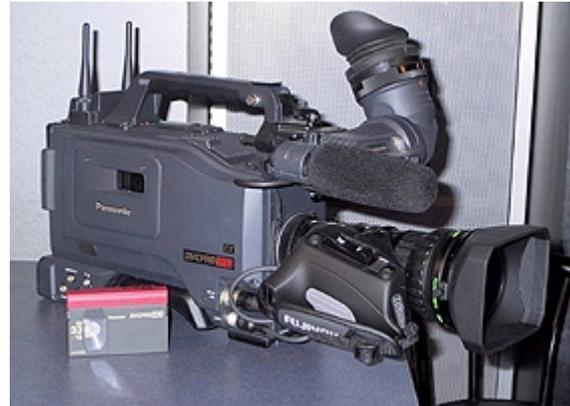
**Noch ein Prototyp: Ein HD-Camcorder im DVCPROHD-Extended-Format, das dank schmalerer Spur auf dem Band längere Aufnahmezeiten pro Kassette ermöglicht.**
