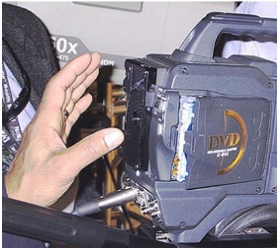
8-cm-DVD-RAM auf. Die mögliche Aufzeichnungsdauer liegt laut Hersteller zwischen 18 und 60 Minuten. Der Dock-Recorder soll auch FBAS- und Y/C-Ein-/Ausgänge aufweisen, für den Ton ist er mit Cinch- und Miniklinken-Buchsen bestückt. Außerdem ist der Recorder auch mit einem kleinen 3,5-Zoll-Farbdisplay ausgerüstet.
