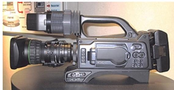
pakten Single-Piece-Camcorders mit dem gleichen Aufnahmeprinzip. Das Kamerateil soll mit drei Halbzoll-IT-CCD-Chips mit je
