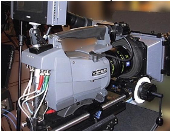
miertes 4:4:4-RGB-Signal ab, ähnlich dem, das üblicherweise von digitalen Filmab-tastern ausgegeben wird. Dieses Signal lässt sich auf Harddisk aufzeichnen, etwa auf die tragbaren Speichermedien der Firma Director's Friend. Die Datenmen-gen, die dabei entstehen, liegen nochmals deutlich über denen, die derzeit Sonys 24P-HD-Camcorder aufzeichnet.
