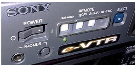
Die Network-Taste und die LED zeigen an: dieser Recorder hat einen Ethernet-Anschluss.
