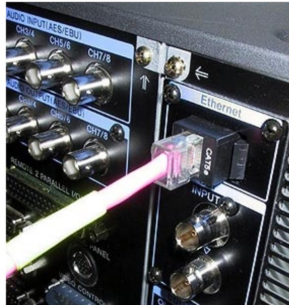
Noch ungewohnt bei einem Tape-Recorder: Gigabit-Ethernet-Anschluss auf der Rückseite.
