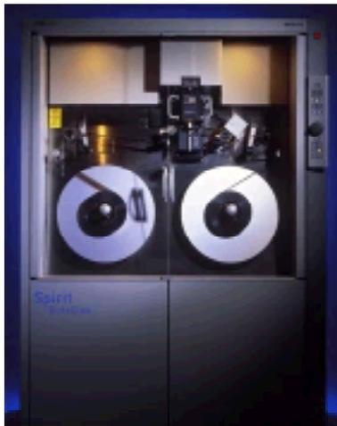
Das Front-End des 4K-Moduls, also alles was die Optik betrifft, kommt von Kodak, alles andere von Thomson. Obwohl als Scanning Modul gedacht und ausgeführt, enthält Spirit 4K laut Hersteller auch einen neuen Teil des digitalen Processings: Es werden farbkorri-
