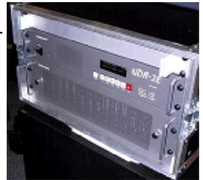
Im Flightcase: Steuer- und Speichereinheit des UDR-2E.
