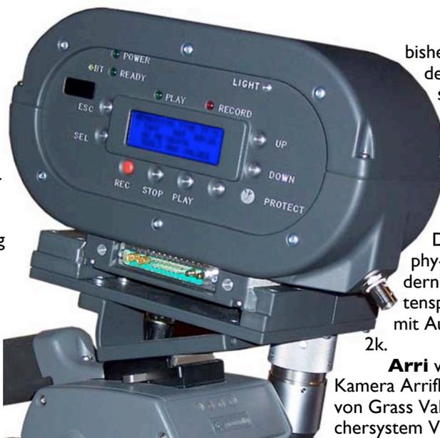
bisher. Das Kürzel UDR in der Typenbezeichnung steht für Universal Data Recorder und verdeutlicht, dass der Hersteller sein System keineswegs nur als Daten-Entladestation beim Drehen mit Digital-Cinematography-Equipment sieht, sondern auch als zentralen Datenspeicher für Filmdateien mit Auflösungen bis zu 4k x 2k.
