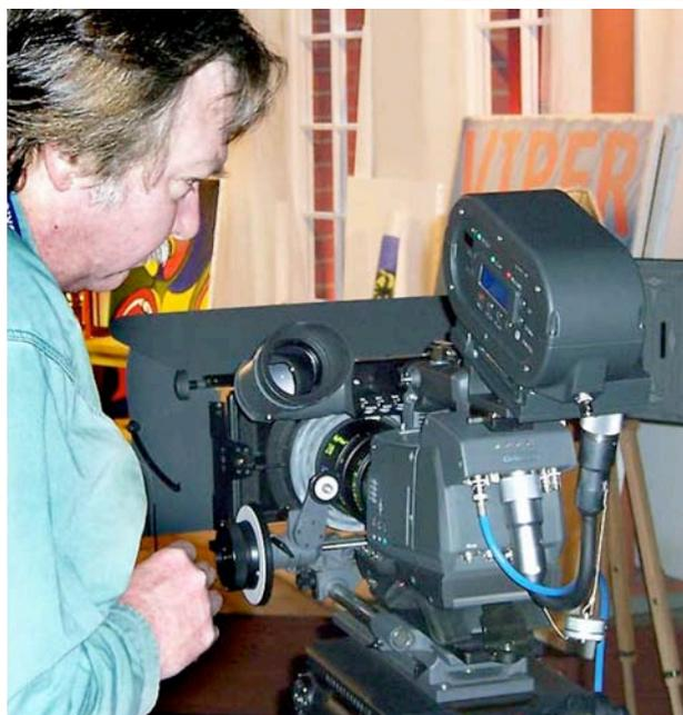
**Venom FlashPak wird wie ein Filmmagazin an die Kamera angesetzt. So will auch Arri die Festspeichereinheit an seiner digitalen Kamera D-20 (rechts oben) nutzen.**
