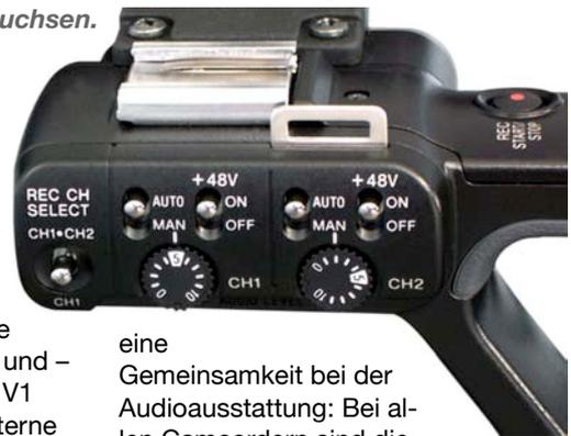
eine Gemeinsamkeit bei der Audioausstattung: Bei allen Camcordern sind die XLR-Buchsen suboptimal positioniert: Stets stehen die Stecker angeschlossener Mikros oder Line-Quellen ungeschickt seitlich heraus, hängen Kabel mehr oder weniger störend im Weg.
