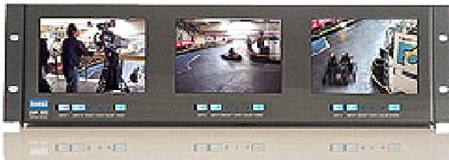
Router integriert. Weitere Eckdaten: automatische PAL- oder NTSC-Erkennung, 10-Bit-Processing für 270-Mbps-SDI-Inputs, analoger Output des ausgewählten Eingangssignals, direkte Einstellmöglichkeit für Helligkeit, Kontrast und Auswahl des Eingangs sowie ein Tally-Light und GPI-I/O-Signal.
