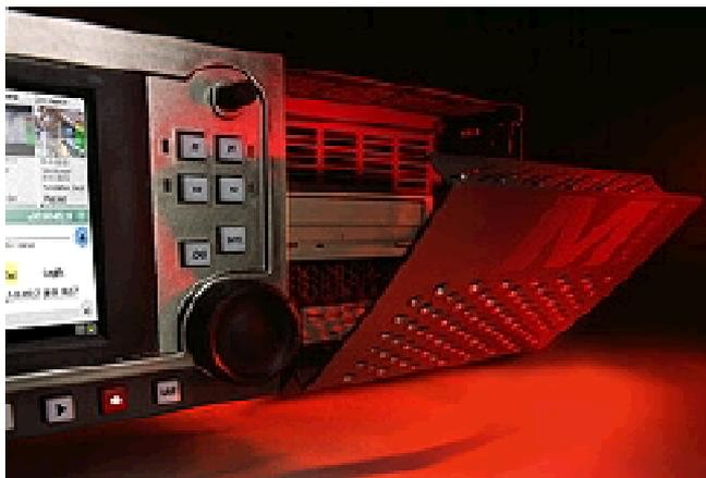
Hinter der Frontklappe verbirgt sich ein Einbauschacht, in den sich Laufwerke für PC-Wechselmedien montieren lassen.
