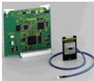
IEEE-1394-Interface-Board mit der Bezeichnung AJ-YAD955G im Programm. Darüber lassen sich digitale Videosignale mit Datenraten von 25 oder 50 Mbps verlustfrei übertragen.
