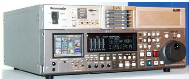
ler die Konvertierung von SD- und HD-Material. Das Frontpanel des Recorders sieht aus wie das eines klassischen Editing-Recorders und ist zudem mit einem LC-Display mit 2,7 Zoll Diagonale ausgerüstet. Via RS-422A, RS-232C oder GPI lässt sich der Recorder extern steuern. In Europa soll es den Studiorecorder Anfang
