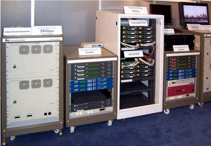
Das Signalprocessing von Ultra-HD ist aufwändig und sperrig – aber es funktioniert schon.
