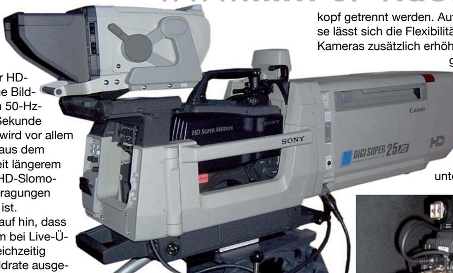
*Oben: Die Super-Slomo-Kamera HDC-3300 erreicht bei voller HD-Auflösung die dreifache Bildfrequenz, kann also im 50-Hz-Markt 150 Bilder pro Sekunde erfassen.*
