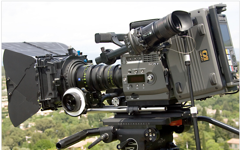
Der Kamerakörper selbst ist relativ kompakt, erst mit angedocktem Recorder und weiterem Zubehör wird die Kamera groß.
