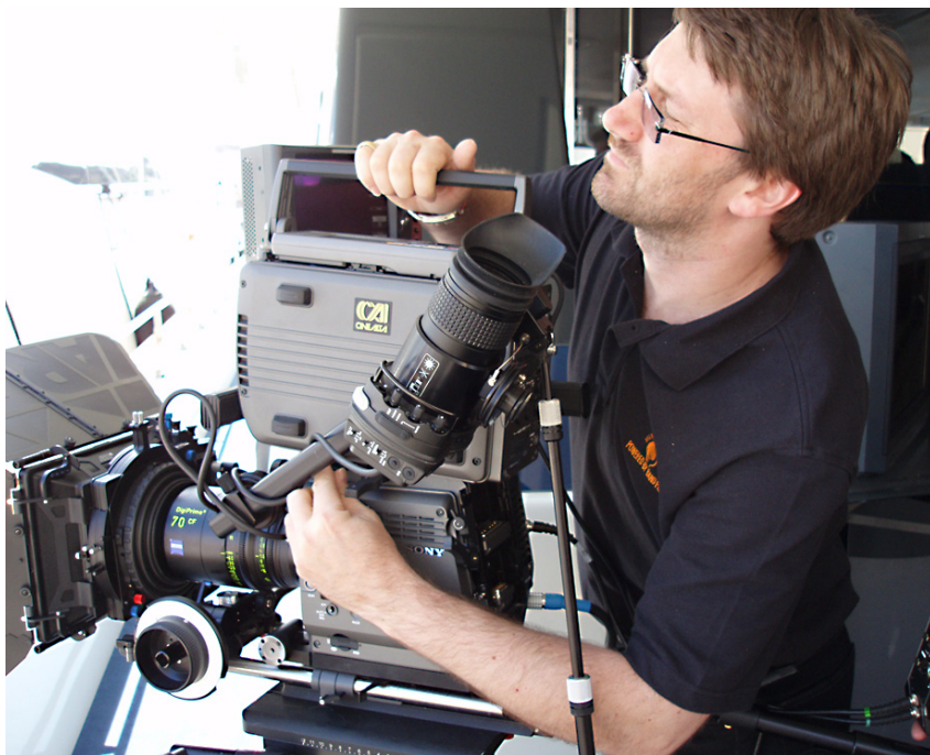
Band-Pro-Spezialist Hendrik Vogt zeigt, wie der SRW-1-Recorder ohne Kabelverbindung und ohne Prozessorteil direkt am Kamerakörper aufgesteckt werden kann. Die beiden Anflanschen ermöglichen das variable Anbringen des Recorders auf der Rückseite oder auf der Oberseite.
