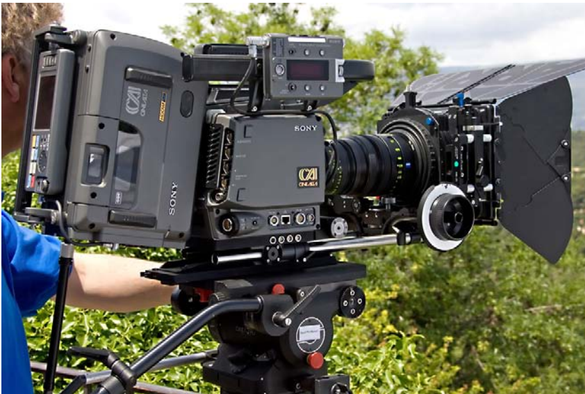
12- und 24-Volt-Buchsen sowie die baulichen Gegebenheiten der F23 erlauben die Verwendung von filmtypischem Zubehör.
