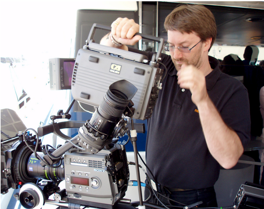
Band-Pro-Spezialist Hendrik Vogt zeigt, wie der SRW-1-Recorder ohne Kabelverbindung und ohne Prozessorteil direkt am Kamerakörper aufgesteckt werden kann. Die beiden Anflanschen ermöglichen das variable Anbringen des Recorders auf der Rückseite oder auf der Oberseite.
