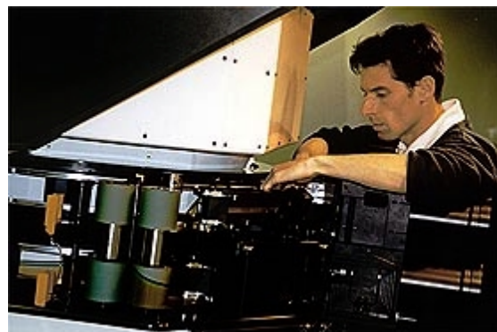
Objektive und Filmtransport für die beiden getrennten Filmstreifen liegen bei der 3D-Ausführung des Imax-Projektors horizontal übereinander.
