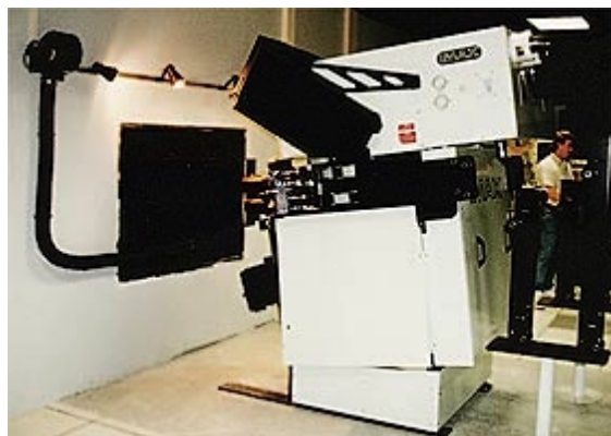
Der Imax-Projektor arbeitet nach dem Rolling-Loop-Prinzip.
