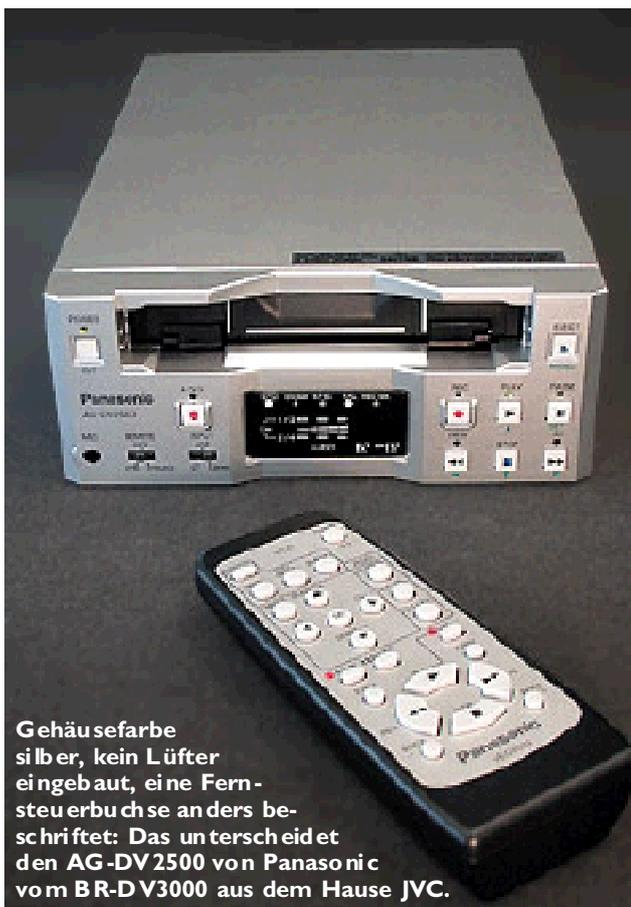
Gehäusefarbe silber, kein Lüfter eingebaut, eine Fernsteuerung anders beschriftet: Das unterscheidet den AG-DV2500 von Panasonic vom BR-DV3000 aus dem Hause JVC.
