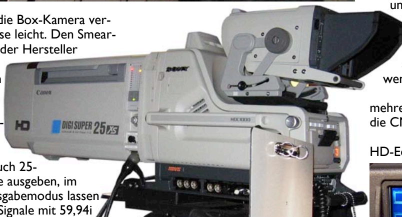
Die Studiokamera HDC-1000 von Sony ist nach Herstellerangaben eines der ersten Modelle einer neuen Linie von Multiformat-HD-Kameras.
