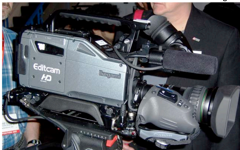
Arbeitet im HD-Modus mit dem DNxHD-Codec von Avid: Editcam HD, der bandlose HD-Camcorder von Ikegami.
