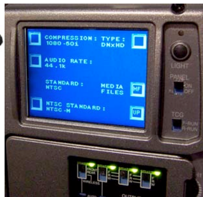
Arbeitet im HD-Modus mit dem DNxHD-Codec von Avid: Editcam HD, der bandlose HD-Camcorder von Ikegami.
