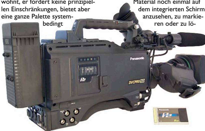
möglicher Zusatzfunktionen. Panasonic hebt in verschiedenen Unterlagen die prinzipiell geringe Leistungsaufnahme von P2-Equipment hervor. Dennoch ist der Camcorder standardmäßig mit einem Akkugehäuse bestückt, das zwei Akkus fasst. In der Praxis zeigte sich, dass das auch sinnvoll ist - auch allein schon deshalb, weil man mit den vielen neuen
