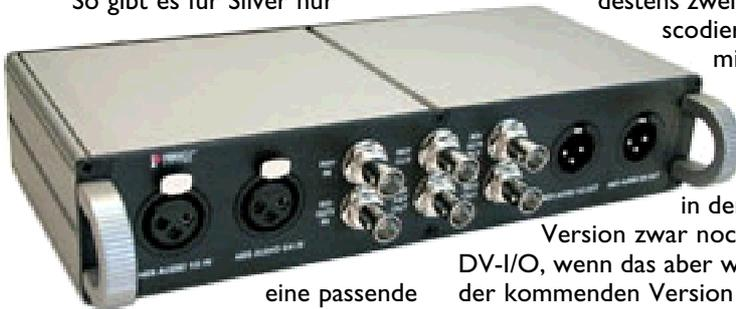
Anschlussbox, und die hat keine Ref-In-Buchse und nur zwei Audio-Ausgänge. Für Chrome stehen dagegen unterschiedliche Anschlussboxen zur Verfügung, die nicht nur über einen Ref-In-Anschluss verfügen,
