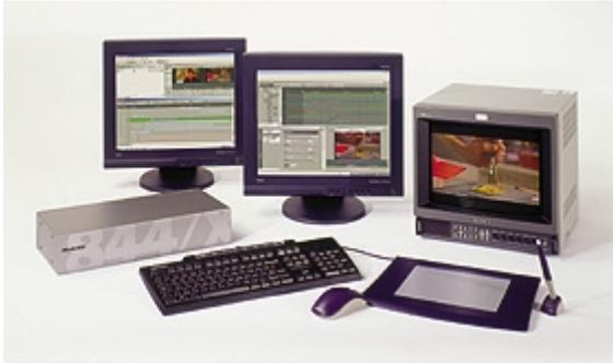
844/X ist die jüngste Entwicklung von Media100 und zielt auf den Multi-Layering-Markt. Neue Software, neue Boards und die ausschließliche Lieferung als Komplettsystem sollen weitestgehende Echtzeit-Funktionalität bei Arbeiten mit unkomprimiertem Material bieten, auch wenn mit vielen Layern gearbeitet wird.
