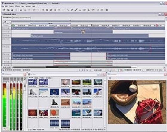
Velocity von der Leitch-Tochter dps besteht aus einem Board und eigener Software, die in einem vorkonfigurierten Windows-Rechner ausgeliefert werden. Damit lässt sich unkomprimiertes Material mit umfangreicher Echtzeit-Funktionalität bearbeiten.
