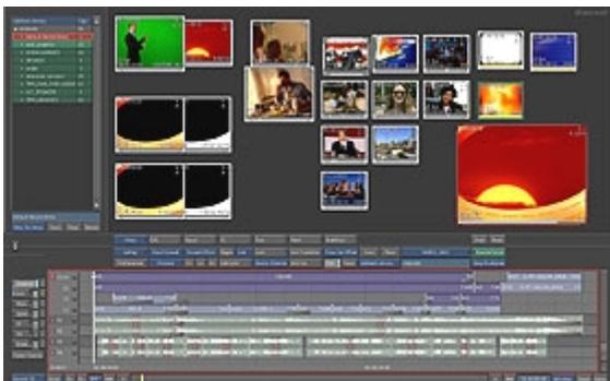
Smoke unterscheidet sich von Fire unter anderem durch die geringere Maximal-Auflösung, die aber mit 2K immer noch im High-End-Bereich liegt. Zudem läuft Smoke auf einer kleineren SGI-Maschine, einer Octane.
