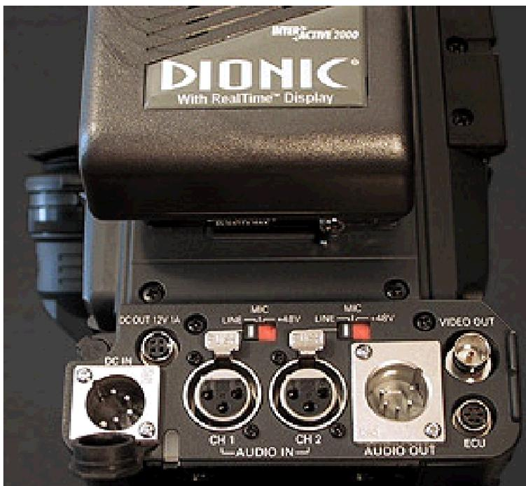
Als Line-Audio-Ausgang setzt Panasonic aus Platzgründen auf eine 5-Pin-XLR-Buchse. In den meisten Fällen, in denen man die Audio-Out-Buchse des Camcorders braucht, wird man da wohl in der Praxis einen Adapter einsetzen müssen.
