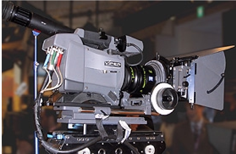
Thomson hat die Viper Filmstream Kamera zur IBC nochmals überarbeitet und mit einigen neuen Features versehen. So lässt sich die Kamera jetzt mit einem flexibleren Kabel mit dem Director's-Friend-Medium verbinden.
