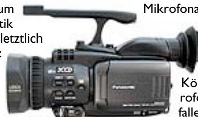
Mikrofonadapters lassen sich auch auf Line-Betrieb umschalten. Positiv: Handlinggeräusche, die sich per Körperschall auf das Mikrofon übertragen können, fallen beim DVC30 weit
