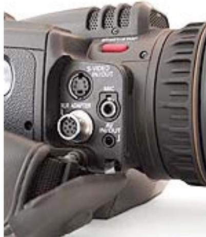
**Oben: Neben den üblichen Anschlüssen weist der DVC30 auch eine Buchse für den Anschluss des XLR-Adapters auf.**
