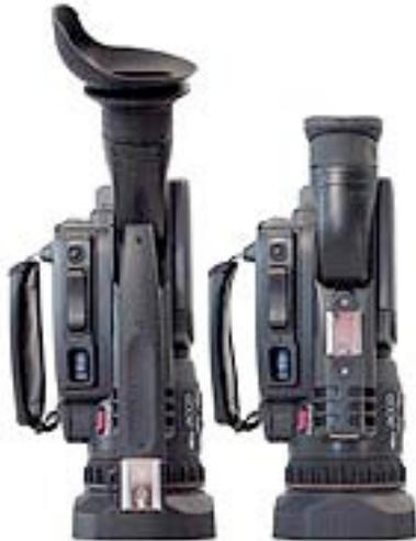
Bei montiertem Griff sitzt der Zubehörschuh weiter vorne, der Sucher kann nach hinten ausgezogen und mit der deutlich größeren Augenmuschel bestückt werden.
