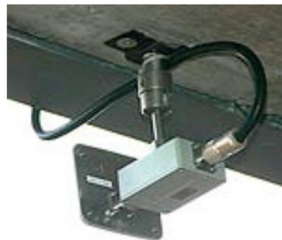
**Zwei solche, etwa handteller-große Diversity-Antennen sorgen im Gottlieb-Daimler-Stadion für drahtlose MPEG-Live-Übertragung.**
