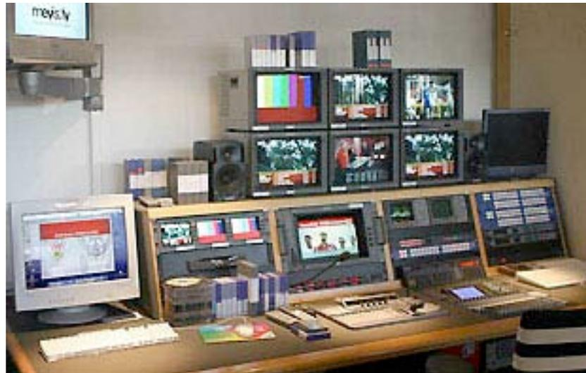
**Am Produktionsplatz liegen bei Veranstaltungen bis zu sechs verschiedene Feeds an. Das können einzelne Kamerasignale sein, der Clean Feed eines Ü-Wagens, aber auch per Satellit empfangene Programme. Die Feeds werden von hier aus auf die Monitore im Business-Bereich des Stadions verteilt. Bis zu drei separate Programme sind dabei gleichzeitig möglich.**
