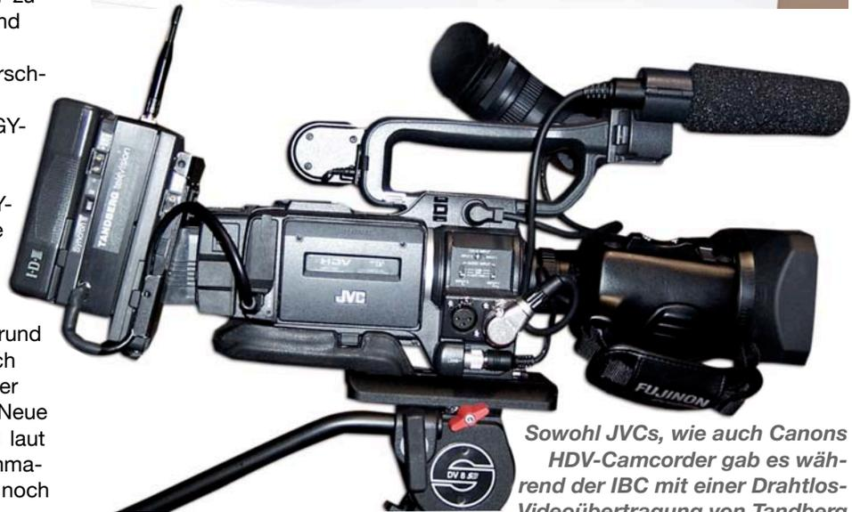
*Sowohl JVCs, wie auch Canons HDV-Camcorder gab es während der IBC mit einer Drahtlos-Videoübertragung von Tandberg zu sehen, die das HDV-Signal direkt überträgt.*
