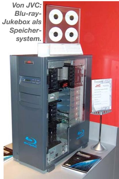
JVC präsentierte eine Speicherlösung, die auf Blu-ray Disc basiert. Insgesamt drei Basismodelle umfasst die MC-BLX Produktfamilie, die je nach Konfiguration Speicherkapazitäten von 2,5 Terabyte bis derzeit maximal 30 Terabyte pro Gerät erreicht. JVC hebt bei den Speicherlösungen die robusten und
