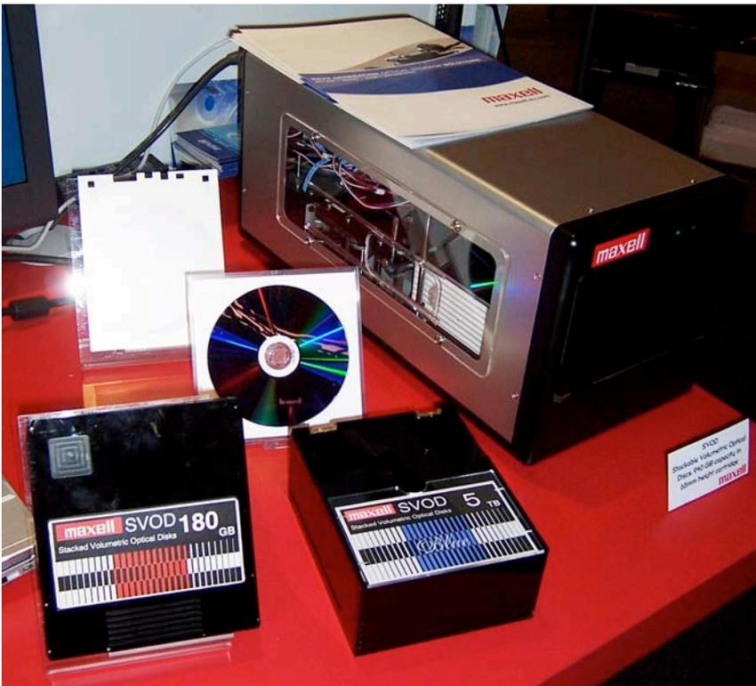
SVOD von Maxell nutzt Stapel von dünnen Speicherfolien in einer Cartridge um große Datenmengen zu speichern.
