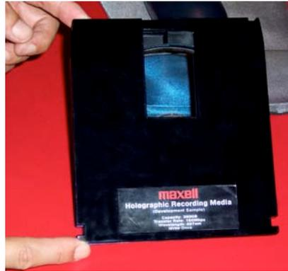
*Inphase entwickelte die Technik und das Laufwerk, von Maxell kommen die Speichermedien: Die Holo-Disc soll zunächst 800 GB später 1,6 TB speichern können.*
