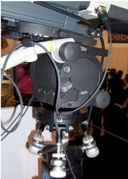
**Prototyp eines Stativkopfes, der mit dem Bildstabilisator eines Canon-Objektivs kommuniziert, um die Fehlkorrektur am Anfang gewollter Kamerabewegungen zu unterbinden.**
