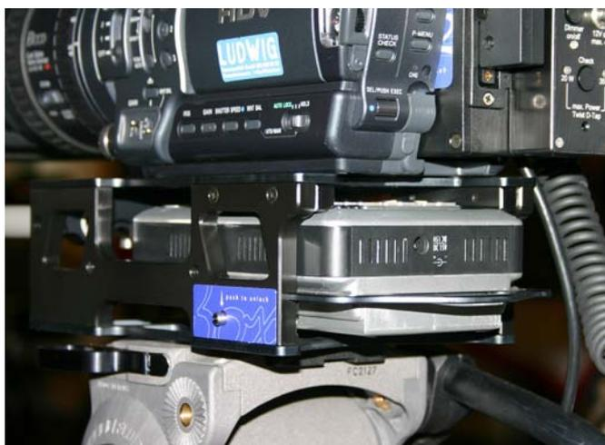
**Bebob's »Box« ist ein stabiles Schubladenmodul das den Diskrecorder Firestore FS4 aufnimmt oder auch professionelle Akkus, wenn man diese mit Kompakt-Camcordern nutzen will.**
