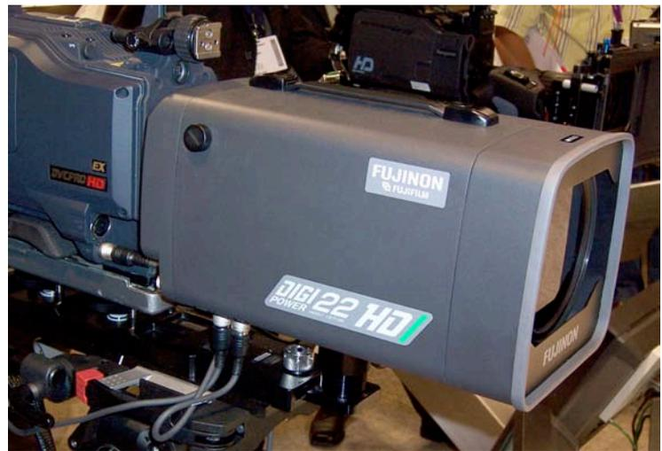
**Wie die großen Box-Type-Objektive hat Fujinon auch das kleinere 22fach-Objektiv mit Funktionen wie DigiPower und LED-Anzeigen für Zoom, Iris und Extender ausgerüstet und auch das Fokuspumpen nach eigenen Angaben vollständig eliminiert.**
