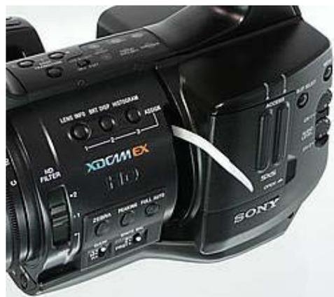
Der PMW-EX1 ist im doppelten Sinn eine »Slot-Machine«: Außer den SxS-Slots gibt es auch einen durchgehenden Schlitz im Gehäuse, über den der Camcorder die im Inneren entstehende Hitze abgeben kann. Hier durch einen Kabelbinder verdeutlicht, den die Tester (natürlich bei ausgeschaltetem Gerät) vorsichtig von hinten durch das Gehäuse geschoben haben.
