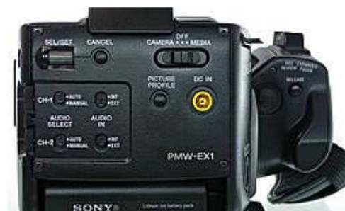
... und mit Schaltern auf der Rückseite wird festgelegt, welche Tonquelle wie in welchem Kanal aufgezeichnet werden soll.
