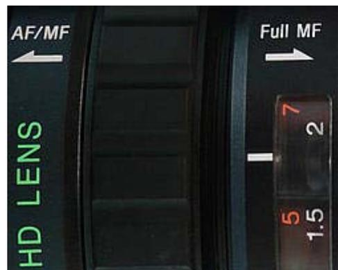
Der Objektivring lässt sich in Längsrichtung verschieben und so zwischen mechanischer und elektrischer Kopplung umschalten. Die Bezeichnungen hierfür gehören zu den Marketing-Schmankerln: Neben »Full HD« bietet der EX1
