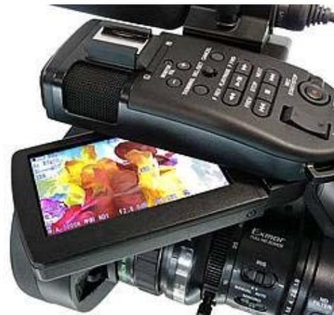
Auf Wunsch verschwindet der Klappschirm in der Ruheposition unter dem oberen Bedienfeld und dem eingebauten Mikro.
