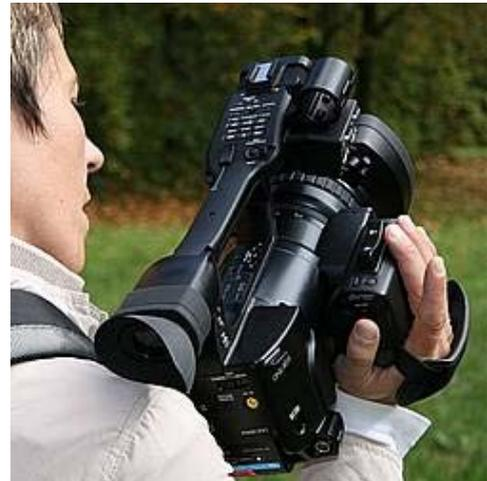
Sony hat den EX1 als Handheld-Camcorder mit ausklappbarem Farbdisplay konzipiert. Insgesamt ist der Camcorder mit seinen 2,865 kg Gewicht in betriebsbereitem Zustand allerdings dafür etwas schwer geraten.
