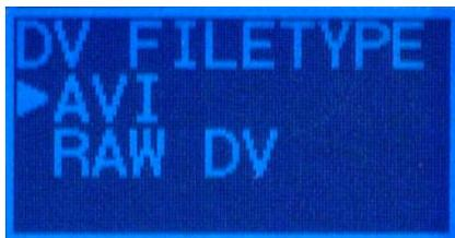
Der Festplatten-Recorder HVR-DR60 kann DV-, DVCAM- und HDV-Signale aufzeichnen. Er lässt sich via Firewire an den Camcorder anschließen und bietet eine Speicherkapazität von 60 GB. Ohne Akku wiegt das Gerät nur 227 g. Der Sony-Festplatten-Recorder DR60 zeichnet mit dem gängigen FAT32-Dateisystem auf und arbeitet mit zwei Aufnahme-Dateiformaten: .m2 für HDV-Aufnahmen und .AVI für DV- und DVCAM-Aufnahmen. Prinzipiell steht ein Video- und ein Computermodus für das Gerät zur Auswahl.
