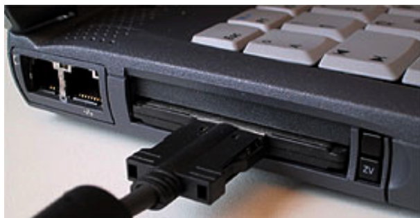
Nur ein Kabel wird für die Steuerung externer Geräte und den Video/Audio-Transfer zwischen Laptop und Peripherie benötigt.
