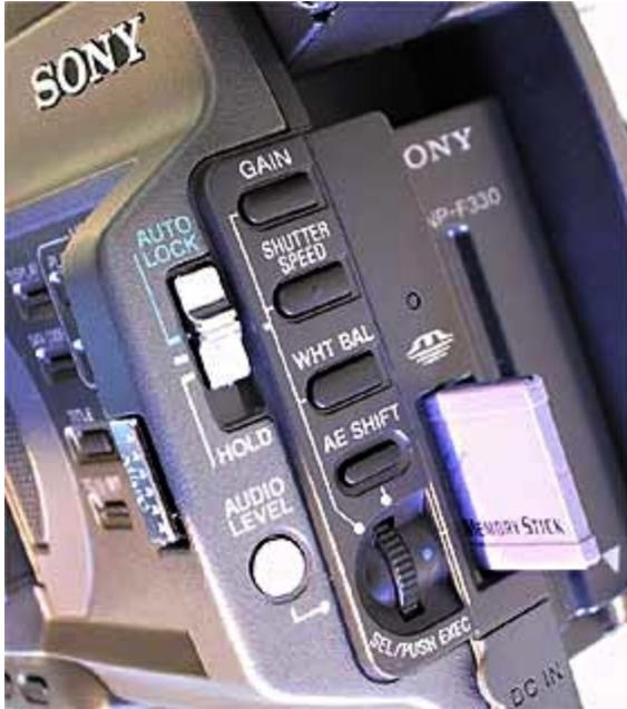
Der Memory-Stick und die hinteren bedien-Elemente des DSR-PD150.
