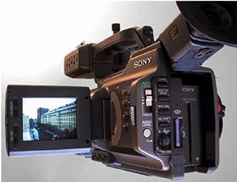
**Durch die geänderte Tastenbelegung beim DSR-PDI50 muss der LC-Schirm immer ausgeklappt werden, wenn Menüeinstellungen vorgenommen werden.**
