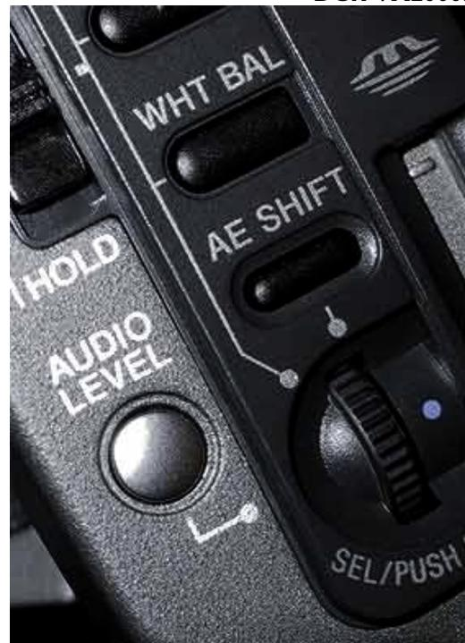
Shift«. Hiermit lässt sich schnell und ohne Umweg über das Menü der Arbeitspunkt der automatischen Blende verändern, also die automatische Belichtungssteuerung auf
