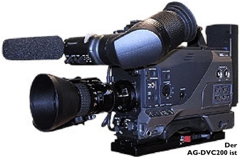
Der AG-DVC200 ist ein reiner DV-Camcorder, der mit drei Halbzoll-Chips bestückt ist. Aufgezeichnet wird ausschließlich auf große Standard-DV-Kassetten mit einer maximalen Spielzeit von 276 Minuten. Ohne Objektiv kostet der AG-DVC200 rund 6.900 Euro.
