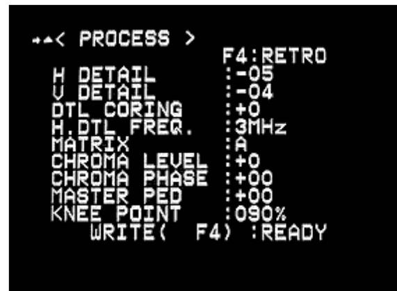
Im Process-Menü stehen umfangreiche Einstellmöglichkeiten für die Signalverarbeitung zur Verfügung. Wer allerdings ohne Fachkenntnis etwa an der Farbmatrix kurbelt, der verbessert damit nicht unbedingt die Ergebnisse seiner Arbeit.
