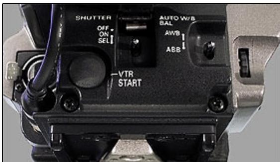
**Die Bedienelemente an der Gerätefront sind tastsicher ausgeführt.**
