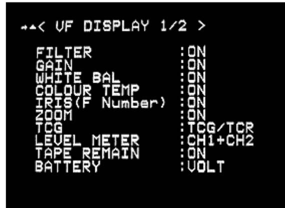
Mit dem zweiteiligen Menü »VF Display« kann eingestellt werden, welche Zusatzinformationen ins Sucherbild eingeblendet werden sollen.
