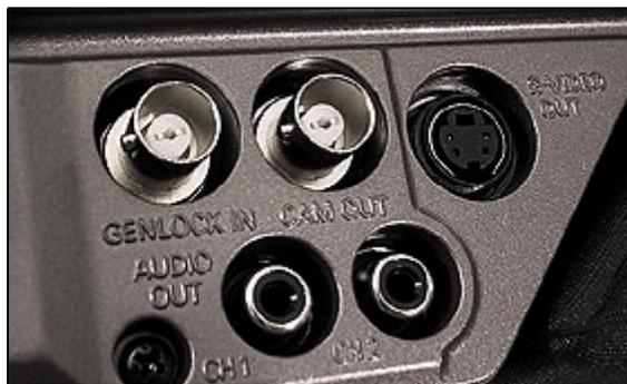
Genlock-In für die externe Synchronisierung des Camcorders sowie ein FBAS- und ein Y/C-Ausgang für das Kamerasignal sind nur drei der sechs Videobuchsen des DVC200.
