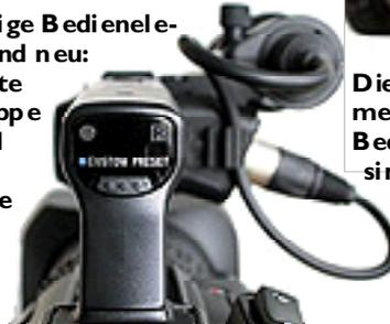
Die meisten Bedienelemente sind vertraut, bewährt und an der gleichen Position geblieben. Den neuen Custom-Schalter (rechts) dagegen betätigten die Tester mehrfach ungewollt.
