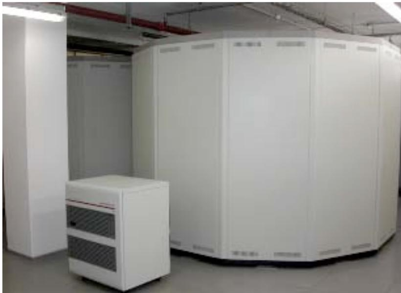
**Der BR setzt zwei redundante Tape-Roboter von StorageTek zur digitalen Archivierung ein.**
