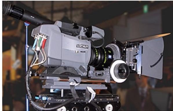
**An der Filmstream-Kamera Viper hat Thomson noch intensiv weiter entwickelt, so haben sich etwa die Anschlüsse verändert. Es gelang, die RGB-Datenleitungen in das Multicore-Kabel zu integrieren, das zudem wesentlich dünner und flexibler ist als bisher.**
