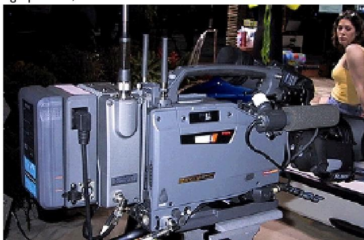
**HDCAM unterschreitet mit dem Camcorder HDW-730 (oben) das Preisniveau von Digital Betacam. HDCAM SR (tragbarer Recorder unten) ist für das High-End von HD-Anwendungen bestimmt.**
